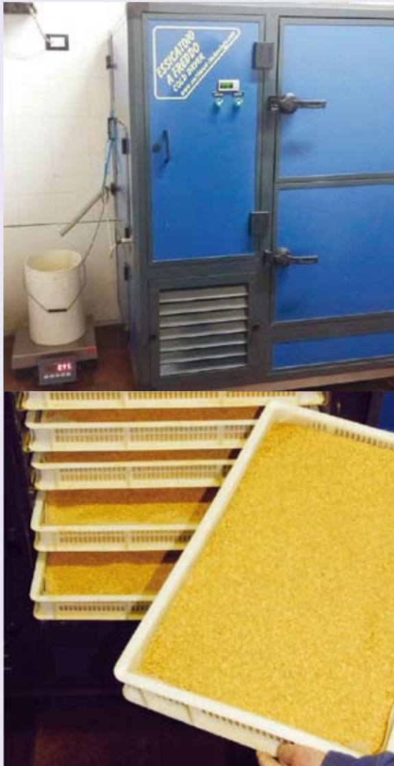
Fig. 6.3: Si noti qui a lato, sulla sinistra del macchinario, il bidone di raccolta dell'acqua posto sulla bilancia per calcolare la percentuale di umidità sottratta al polline che si trova all'interno della macchina.
