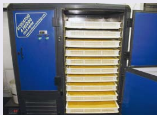
Fig.6.1: Di macchine deumidificatrici ne troviamo sul mercato di diverse dimensioni e modelli. Agiscono tutte sul polline con soffi di aria calda, che rimangono, però, sempre sotto i 38°C per non alterare le qualità del polline.
