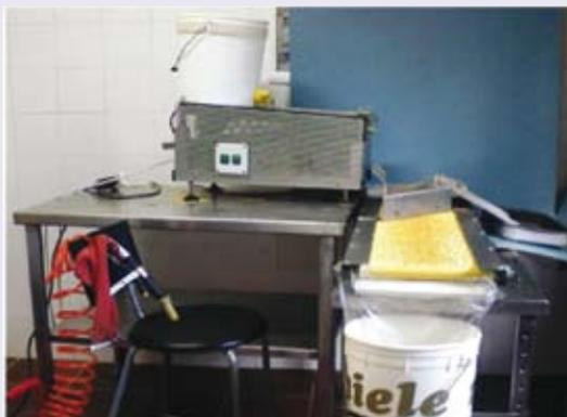
La macchina più semplice, detta “a nastro”, elimina le particelle d'impurità più piccole con un getto d'aria, quindi deposita il polline su un nastro per l'ispezione a vista, dove l'operatore intervenendo con una pistola ad aspirazione asporta eventuali impurità rimaste (più grosse e pesanti del polline).
